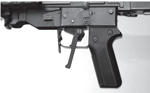
Figure 26: Détente d'hiver pour tireurs gauchers pour F ass 57
