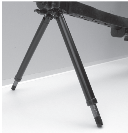
Figura 15: Bipiede regolabile per F ass 57, diversi modelli
