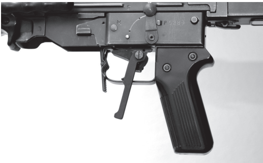
Bild 26: Winterabzug für Linksschützen zu Stgw 57
